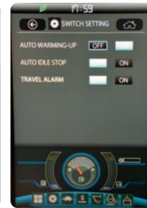
**PRERISCALDAMENTO** È possibile impostare l'avvio temporizzato del motore.
