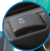
**RIGENERAZIONE AUTOMATICA** Quando l'ECU lo ritiene necessario, il sistema avvia un processo di rigenerazione automatica. In questo caso una valvola parzializzatrice allo scarico permette di elevare la temperatura del filtro antiparticolato in modo che si rigeneri. In questa fase, l'operatore può continuare a lavorare come se nulla fosse. Nel caso si stia lavorando in un ambiente in cui una elevata temperatura allo scarico è sconsigliabile, l'operatore può interrompere e rinviare la procedura.
