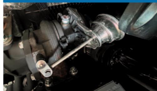
**EGR ELETTRONICO** Sullo Yanmar 4TNV98CT il ricircolo dei gas di scarico è esterno e raffreddato. Grazie al controllo elettronico della valvola attuatrice via ECU, il ricircolo non è continuo, ma avviene solo quando necessario, ottimizzando la combustione, quindi l'efficienza.
