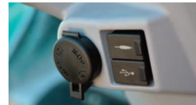
**POSIZIONE PERFETTA** Sotto al porta telefono, sulla console destra, ci sono l'alimentazione 12V e le connessioni usb e jack audio. A questo si aggiunge la radio DAB+ con bluetooth e vivavoce per non lasciare i joystick.
