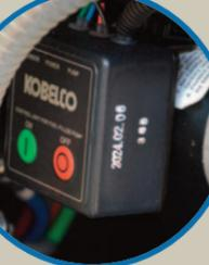
**ARRESTO AUTOMATICO** L'SK85MSR-7 ha il serbatoio gasolio in plastica nella parte anteriore della torretta. Il bocchettone è accessibile salendo sul cingolo, ma a lato torretta c'è una pompa di rifornimento di serie che si arresta al limite del troppopieno.
