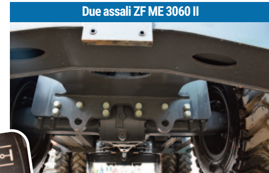
Nuovo ingrassatore alla base del cilindro oscillante
