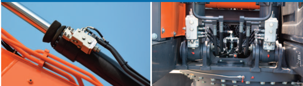
Valvole anticaduta su braccio e avambraccio di serie
