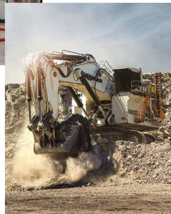
pio stadio che alimentano i Liebherr da miniera, anche in configurazione doppia, ossia con due unità che lavorano in parallelo. A tal proposito va detto che per alcuni modelli il cliente può richiedere anche l'opzione Cummins di pari potenza, ottenuta con motori QSK60 V16 da 60 litri di cilindrata.
