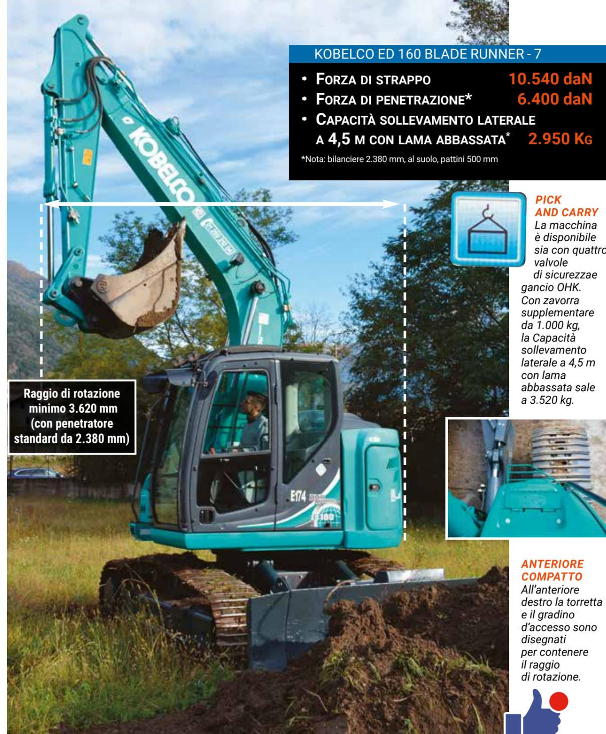
Raggio di rotazione minimo 3.620 mm (con penetratore standard da 2.380 mm)
