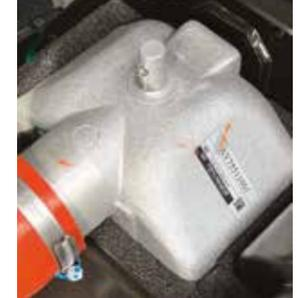
**ALTA QUALITÀ** L'intercooler Tokyo Radiator con estremità in fusione la dice lunga sull'attenzione ai dettagli da parte dei progettisti Kobelco.
