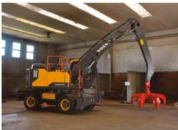
**La cabina elevabile dell'EW200E MH porta lo sguardo dell'operatore a cinque metri d'altezza: più comfort di lavoro e sicurezza. A sinistra, la nuova Volvo, con polpo Rozzi, in fase di traslazione.**
