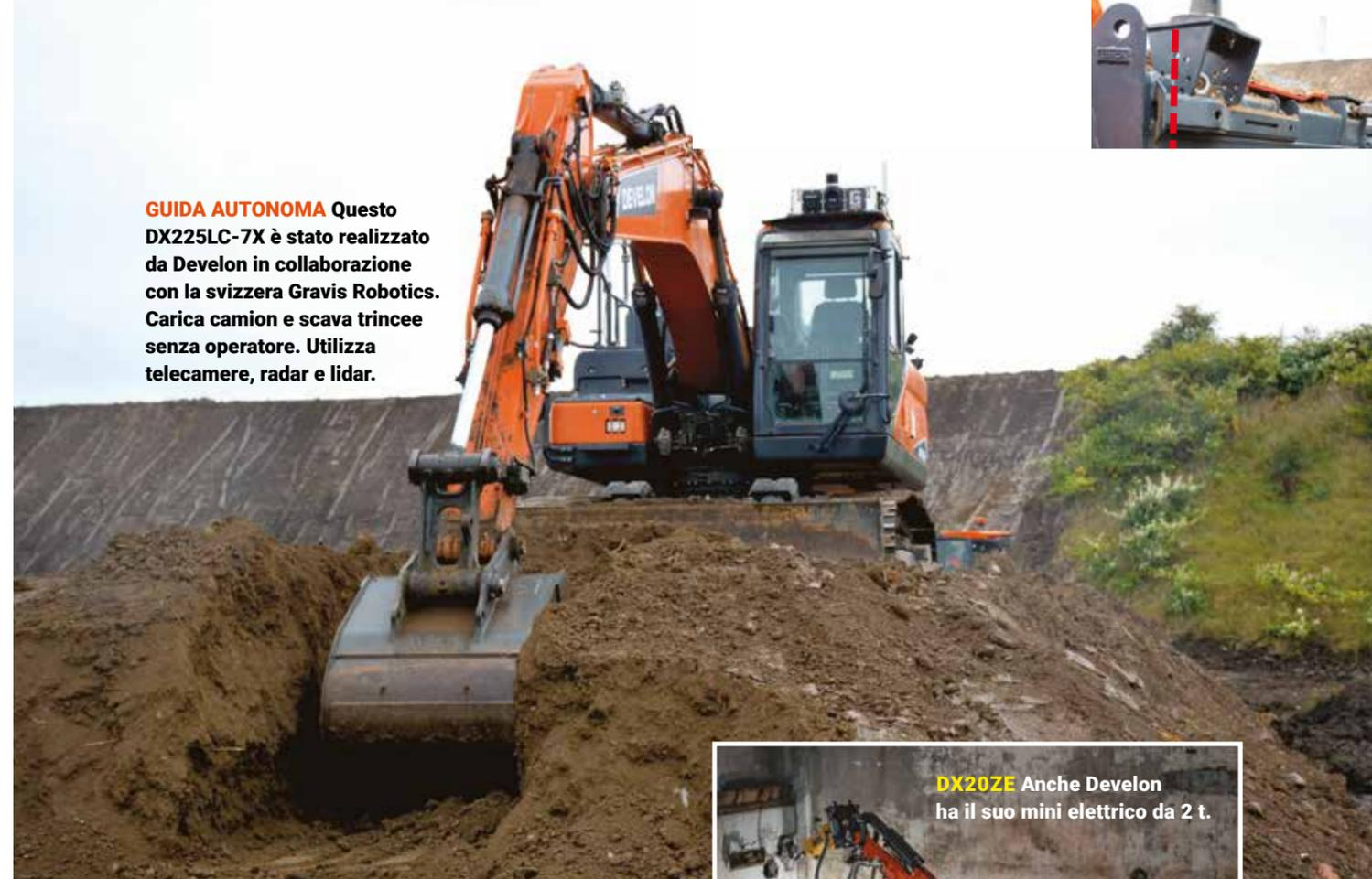
**GUIDA AUTONOMA** Questo DX225LC-7X è stato realizzato da Develon in collaborazione con la svizzera Gravis Robotics. Carica camion e scava trincee senza operatore. Utilizza telecamere, radar e lidar.
