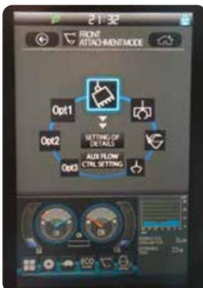
**ATTREZZATURE** Si possono selezionare benna, martello, cesoia, polipo o tilt rotator.
