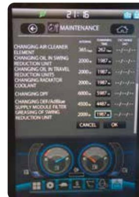
**6.000 ORE** È l'intervallo per la sostituzione o pulizia del filtro antiparticolato.
