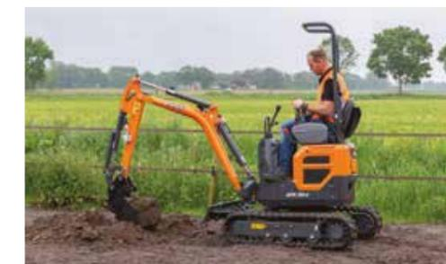
**DX10Z-7** Canopy che non oltrepassa la zavorra posteriore, joystick su console laterali e cilindri sopra al braccio. Piacerà molto in Italia.
