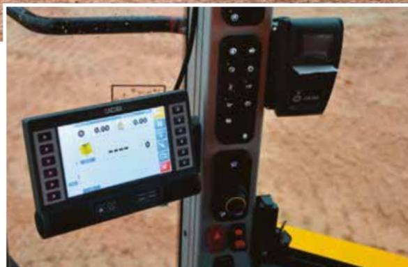
**PESA INTELLIWEIGH E STAMPANTE** Per le pale gommate JCB 427, 437 e 457 è ora disponibile una pesa che funziona con differenti benne e forche, assicurando una precisione elevata visto che ha un margine d'errore del più o meno 2%. Qui sotto, un nuovo telescopico rotativo 558-260 Pro al lavoro con radiocomando.
