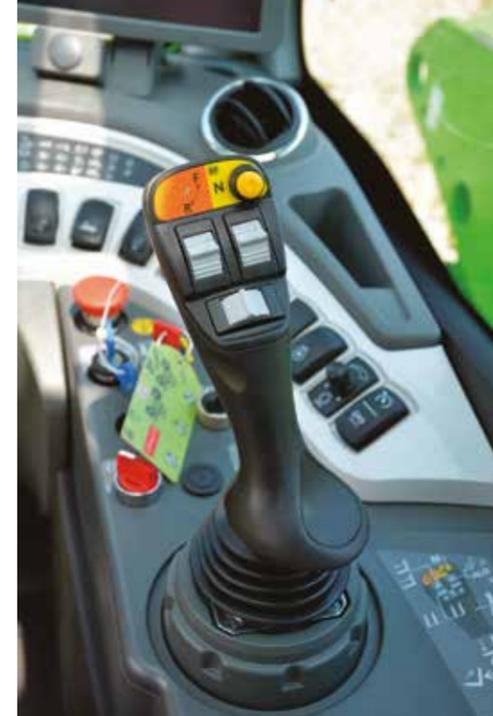
**VOLENDO ORIZZONTALE** Il joystick con supporto alla base è comodo e intuitivo per tutti, ma volendo il cliente che è già abituato ad utilizzare i Roto si legge sempre benissimo e si controlla con selettore rotativo il tipico comando orizzontale che ricorda i manipolatori dei dozer.
