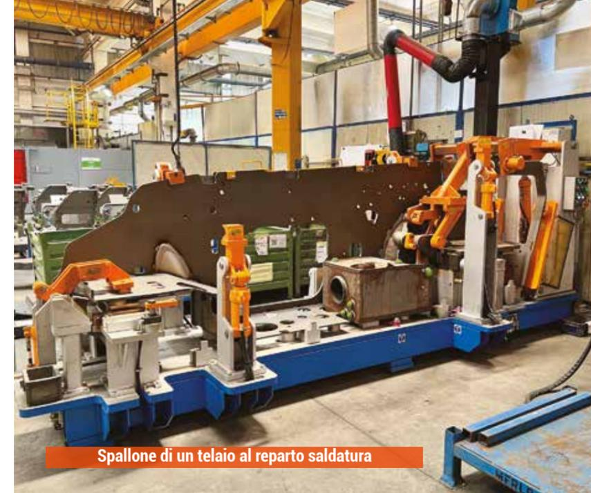
Spallone di un telaio al reparto saldatura
