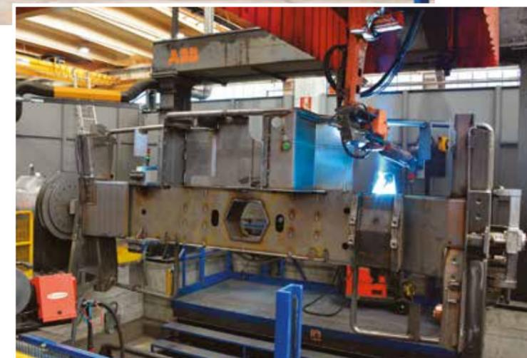
**TAGLIO, PIEGA E...** Per costruire un sollevatore, Merlo parte dalla lamiera e, fusioni a parte, realizza ogni parte strutturale nello stabilimento di San Defendente di Cervasca (CN).
