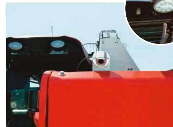
A sinistra due delle quattro telecamere del sistema di videocontrollo Backeye®360 di Brigade Elettronica, nella pagina accanto, in basso, i due radar posteriori.
