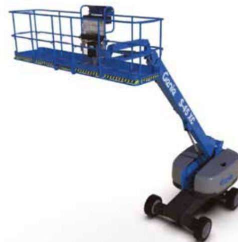
sistema TraX di seconda generazione è disponibile in due dimensioni: una per il telaio piccolo dell'S-45 XC che arriva a 15,6 m di altezza di lavoro e una quello grande dei modelli S-65 XC, Z-62/40 e S-80 J che arrivano rispettivamente ad altezze di lavoro di 21,86 m, 20,92 m e 26,56 m.
