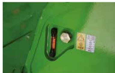
**SERBATOIO OLIO** L'olio idraulico della trasmissione è in un serbatoio metallico da 110 litri di capacità, integrato perfettamente al centro del telaio. Dietro cabina si visualizza il livello a colpo d'occhio.
