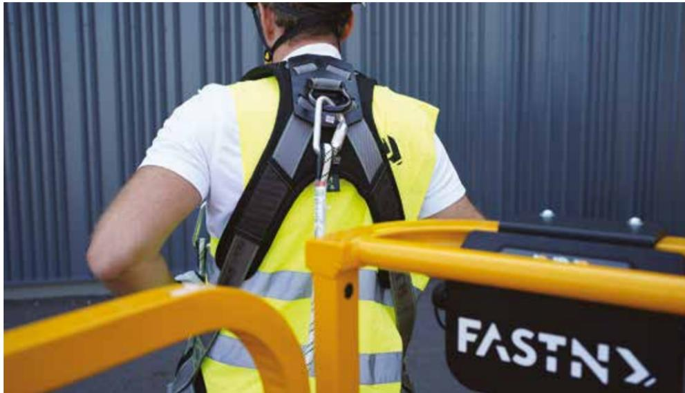
**IL SISTEMA FASTN** è costituito da due "scatole" installate in cesta e connesse. Il dispositivo riconosce quattro tipi di situazioni pericolose.
