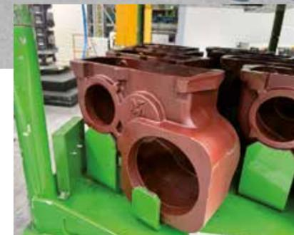
**FINO A 40 KM/H** Il P 50.18 SC Top ha di serie l'esclusiva trasmissione idrostatica Merlo in versione a doppia gamma di velocità: da 0 a 20 km/h, oppure da 0 a 40 km/h. La potenza frenante idrostatica che si genera rilasciando l'acceleratore ricorda i retarder dei camion e riesce a fermare la macchina anche in discesa. A sinistra, la scatola di trasmissione in linea di produzione.
