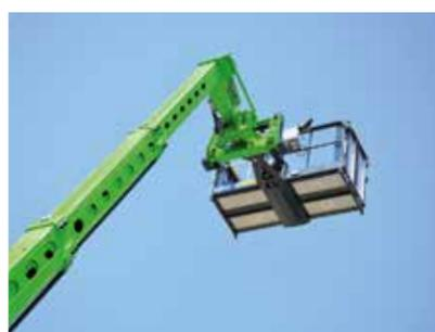
**EMERGENZA** Chi lavora in cesta ha il controllo esclusivo della macchina. Per motivi di sicurezza, nel caso ad esempio l'operatore abbia un malore, è possibile arrestare le funzionalità da terra con un fungo d'emergenza.
