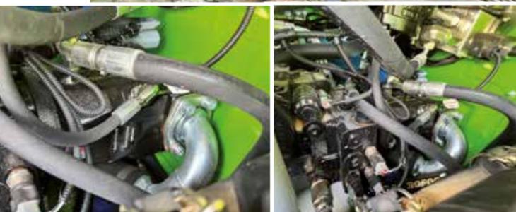
La trasmissione idrostatica progettata in casa ha prestazioni superlative e merita un impianto idraulico dedicato, distinto da quello di lavoro (braccio e linee aux)
