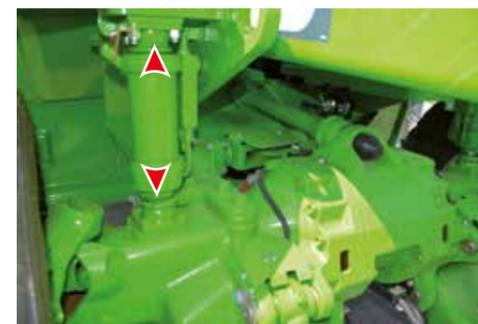
**LIVELLAMENTO TELAIO** Due cilindri idraulici posti tra assale anteriore e telaio permettono di variare di 5° l'inclinazione dello stesso rispetto al terreno. In questo modo si lavora stabilizzati con le curve di carico più prestazionali. È inoltre possibile recuperare pendenza lavorando di stabilizzatori, ma con le curve «su gomma».
