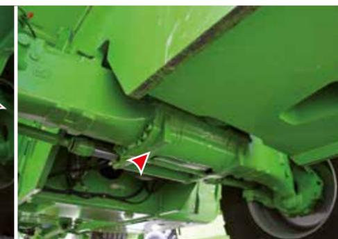
**NON TEME NULLA** Oltre al «franco a terra» elevato, senza dubbio un vantaggio su terreni accidentati, il P 50.18 CS Top ha il sottofondo carenato per proteggere ogni componente. Inoltre, gli «spalloni» del telaio sono disegnati per creare delle slitte che a loro volta proteggono il fondo e i supporti oscillanti dell'assale anteriore. Lo stesso vale per gli assali made in Merlo.
