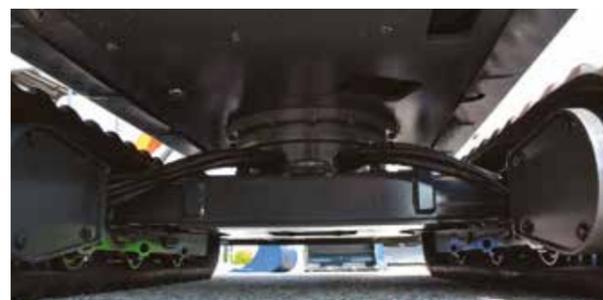
**SOTTOCARRO ALLAGABILE** Sopra si notano gli sfilii a tipo scatolato e le tubazioni idrauliche dirette ai motori di traslazione, protette una ad una con spirali plastiche.
