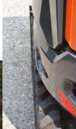
**PIÙ 80 KG DI ZAVORRA** Oltre all'avambraccio standard da 1.030 mm il compatto Develon è disponibile con avambraccio lungo da 1.230 mm e zavorra supplementare (75 mm di sbalzo posteriore in più). La zavorra extra, che aggiunge 80 kg ai 160 kg della zavorra standard, si può montare anche con avambraccio corto.
