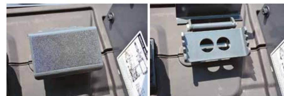
**BRANDEGGIO A PEDALE** A sinistra il pedale per controllare il brandeggio del braccio con tanto di copertura poggia piede.
