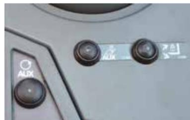
**SCORCIATOIE** Dietro al joystick ci sono tre pulsanti che permettono con un tocco di bloccare o inibire la portata aux e di impedire l'inclinazione involontaria della zattera porta attrezzi.
