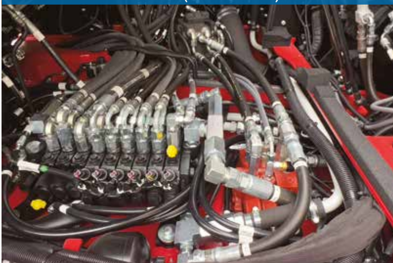
Spole a controllo elettronico
