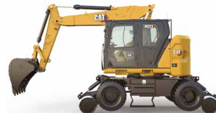
RAIL ROAD Sotto, il nuovo M323 in configurazione ferroviaria. Basato sull'esperienza maturata con il precedente M323F, questo Next Gen incrementa comfort, facilità di manutenzione, prestazioni e sicurezza.
