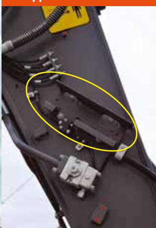
Sensore posizione braccio e avambraccio
