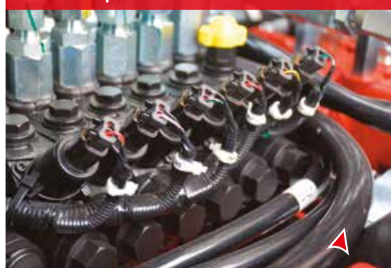
Spole a controllo elettronico
