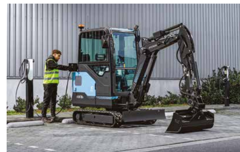
MINI ELETTRICO HX19e Il primo elettrico di Hyundai avrà batterie agli ioni di litio da 32 kWh o 40 kWh di capacità: fino a 7 ore di autonomia e 2.296 kg di peso.
