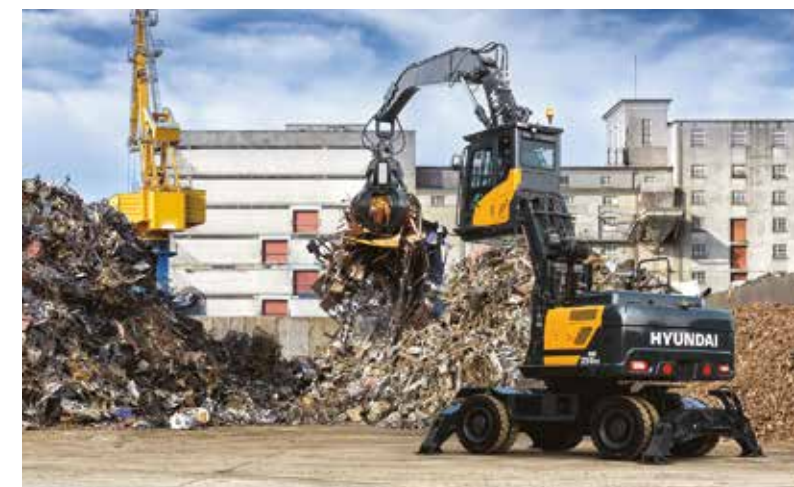
HW250A MH Con un peso operativo di 26,1 t, il nuovo movimentatore dedicato al riciclaggio e al waste ha la cabina elevabile ed è disponibile con diversi bracci.
