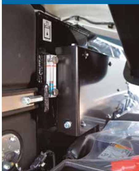
Serbatoio olio metallico
