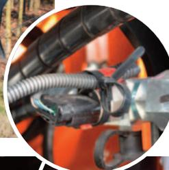
**SENSORE OLIO IDRAULICO**
