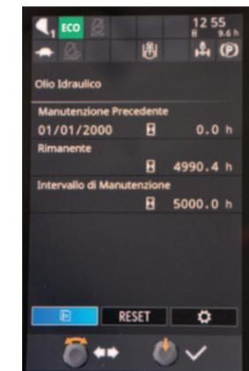
**LONG LIFE** L'olio idraulico si sostituisce a ben 5.000 ore e la sua qualità è monitorata costantemente.
