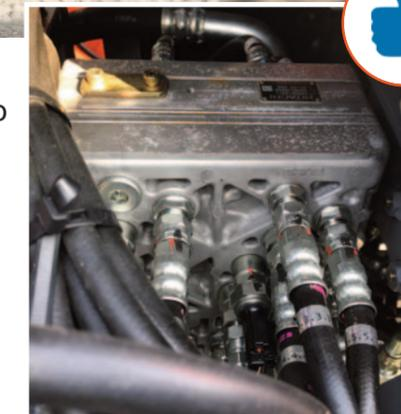
**INTERFACCIA ESCLUSIVA** Il blocco qui sopra ottimizza la fluidodinamica e grazie a restringimenti realizzati ad hoc per assicurare la massima controllabilità e progressione dei movimenti in ogni condizione. Nonostante l'avanzare dell'elettronica, l'identità Hitachi è salva.
