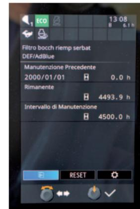
**4.500 E 9.000 ORE** Sono gli intervalli di manutenzione del filtro urea e del nuovo modulo CSF antiparticolato.
