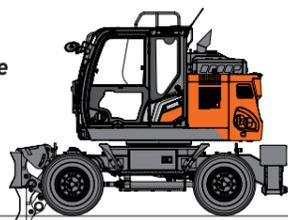
**CON STABILIZZATORI** Aggiungendo gli stabilizzatori posteriori si ha la massima stabilità con buona visibilità sullo scavo e il peso operativo lievita a 15.500 kg. Con 4 stabilizzatori si arriva a 15.800 kg.
