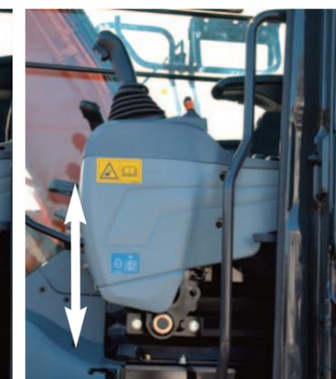
**PIÙ SICUREZZA, PIÙ SPAZIO, PIÙ QUALITÀ** Rispetto ai gommati Serie 6, la cabina Rops Fops è integralmente nuova, più lunga e di generazione CRES 7. Tutta la struttura perimetrale è ora realizzata con scatolati più resistenti (ribaltamento fino a un peso massimo di 16,3 t) e si distingue dalla precedente per l'angolo retto tra montante e tetto. A richiesta si possono avere la griglia superiore OPG Level II apribile (pulizia e uscita di sicurezza) e quella frontale apribile a libro (pulizia).
