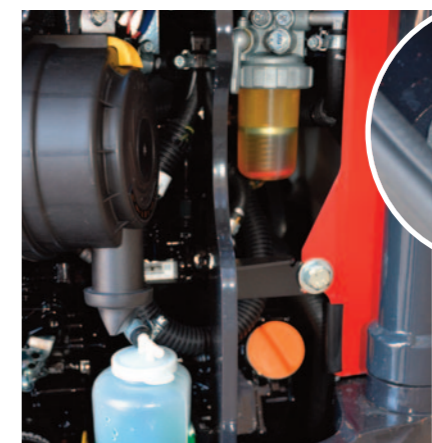
Doppio filtro gasolio con separatore, spurgo e reinnesco con pompa elettrica
