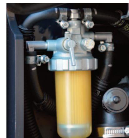
Doppio filtro gasolio con separatore, spurgo e reinnesco con pompa elettrica
