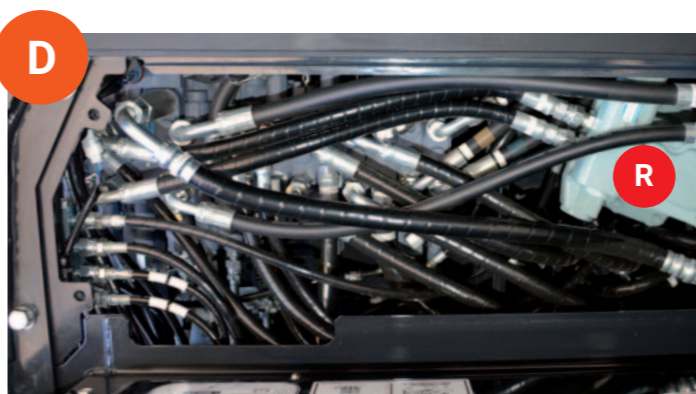
Il serbatoio olio idraulico in metallo assicura pressioni stabili
