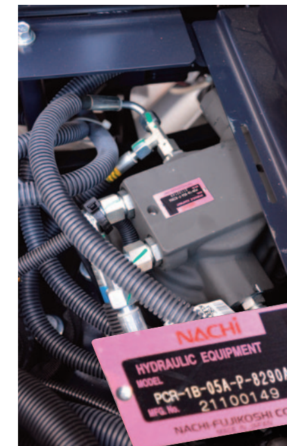
Elettrovalvola per scegliere il singolo/doppio effetto dalla cabina
