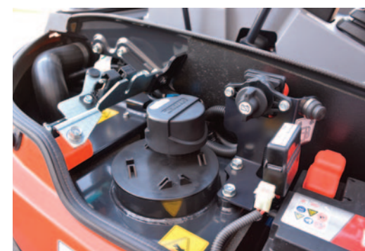
Dal vano attrezzi sottoporta si accede ai solenoidi dei proporzionali
