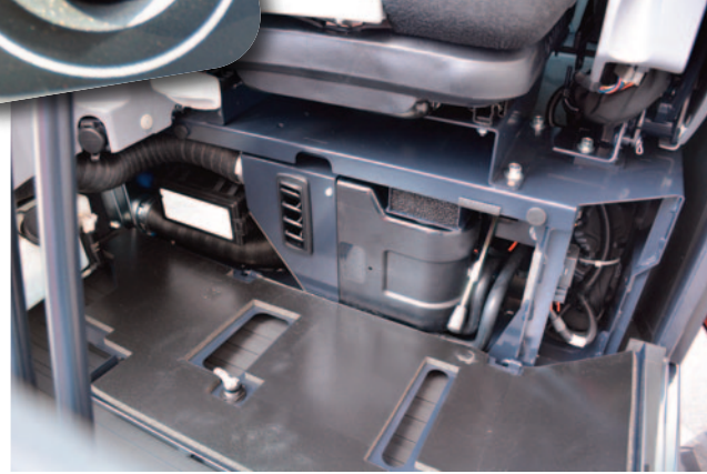
NO CLIMA, SI RISCALDAMENTO L'U27-4 non prevede la possibilità dell'aria condizionata per motivi di spazio, ma ha un vero riscaldamento con 3 bocchette orientabili.
