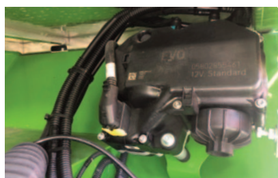
Valvola allo scarico per ottimizzare ed elevare le temperature
