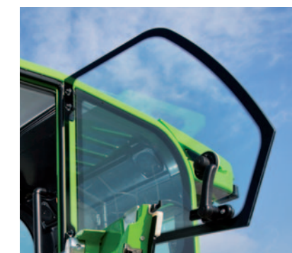
Interno porta con corrimano integrale per agevolare la salita e la discesa sicura
