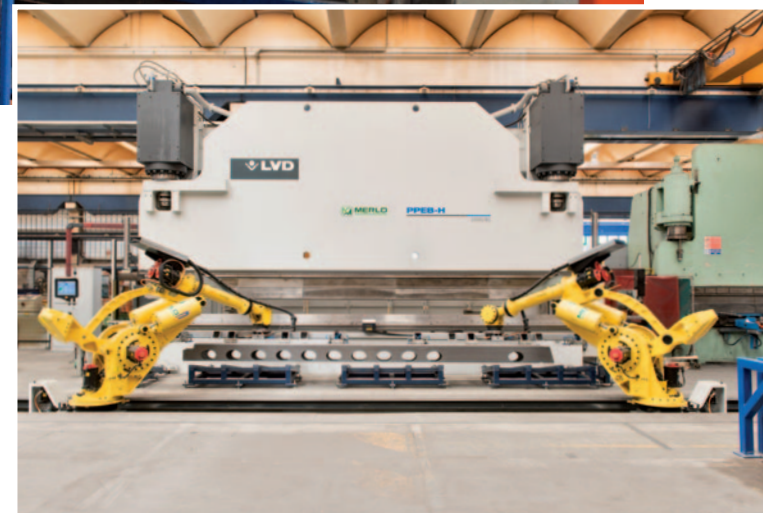
In alto, un telaio ROTO in fase di saldatura robotizzata. Qui sopra, una piegatrice di lamierati totalmente automatizzata introdotta per lavorare 24 ore su 24.
