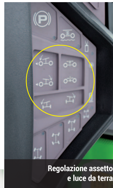
Regolazione manuale degli stabilizzatori
