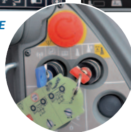
30 SECONDI DI BY-PASS Con la chiave blu si seleziona il controllo da radiocomando, cabina o cesta. Con quella rossa si disattivano i blocchi di sicurezza per 30 secondi e l'azione è rilevata da una scatola nera.
