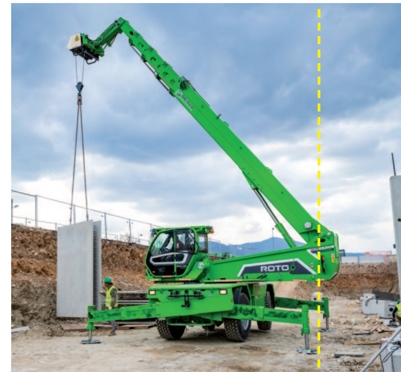
Solo 530 mm oltre l'estensione degli stabilizzatori
