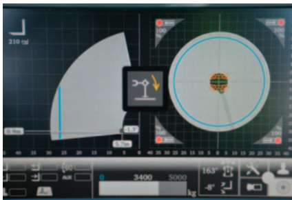
STABILIZZAZIONE Manuale o automatica, la stabilizzazione è monitorata da monitor, via sensori di pressione al suolo, per evitare sorprese.
