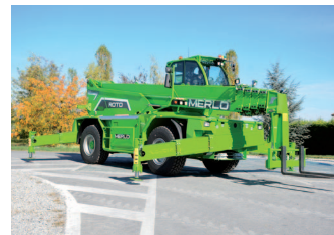
Area di stabilizzazione da 6.910 mm x 6.320 mm
