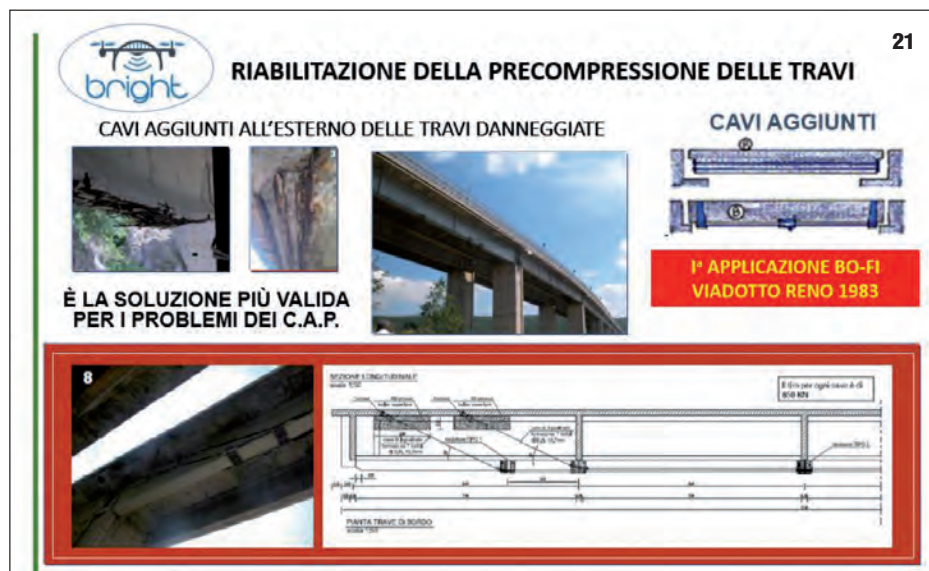
21. Cavi aggiunti per ripristino della precompressione-cavi viplati
