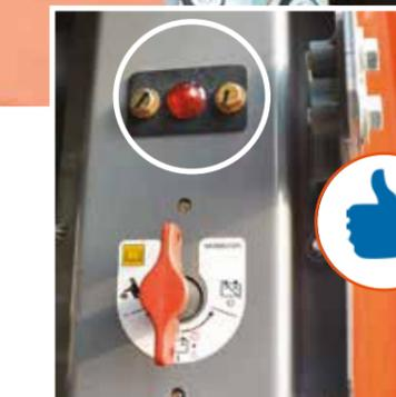
**SPIA ROSSA** Si accende mentre è in atto lo spurgo dell'impianto di urea per evitare cristallizzazioni. È possibile staccare le batterie (2x93 Ah) per manutenzione senza resettare le centraline della macchina.
