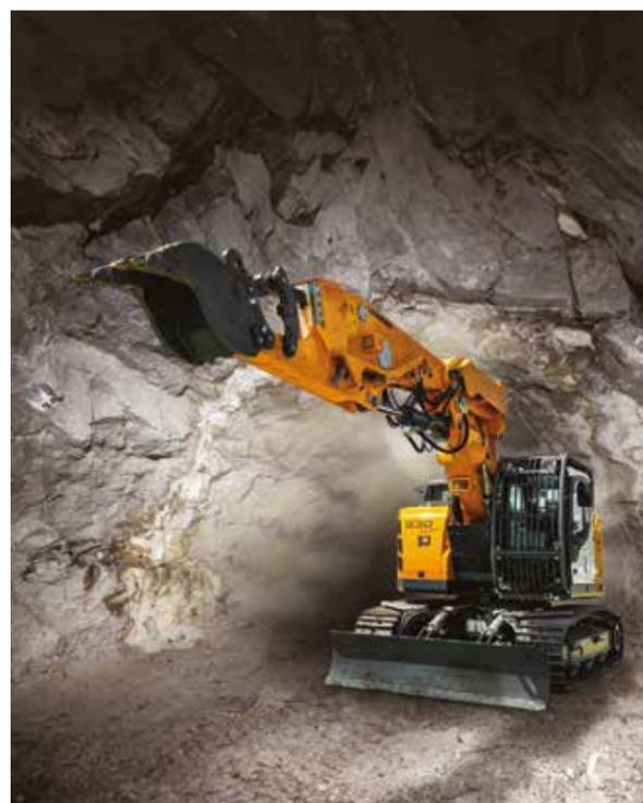
dell'R 930 Tunnel, disponibile in due lunghezze, è dotato di una benna rovescia inclinabile 2 x 45° che permette di seguire il profilo di scavo. Il raggio di sterzata ridotto della macchina e i potenti fari a LED protetti riducono notevolmente il rischio di
