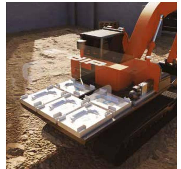
**M**oog Construction, ha lanciato una soluzione che permette di elettrificare macchine movimento terra nuove o già esistenti tramite un sistema modulare di batterie battezzato ZQuip.
