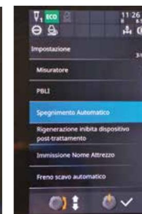
**SPEGNIMENTO REGOLABILE** L'operatore può regolare il tempo d'azionamento dello spegnimento motore.
