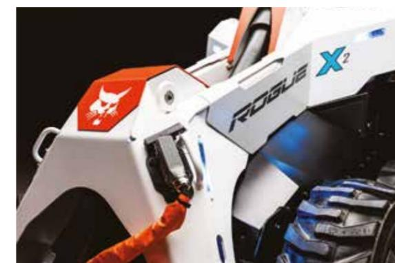
**UN POCO DI OLIO CI VORRÀ? I RogueX e RogueX2 hanno motori di traslazione elettrici e cilindri di sollevamento e richiamo benna senza olio idraulico,**
