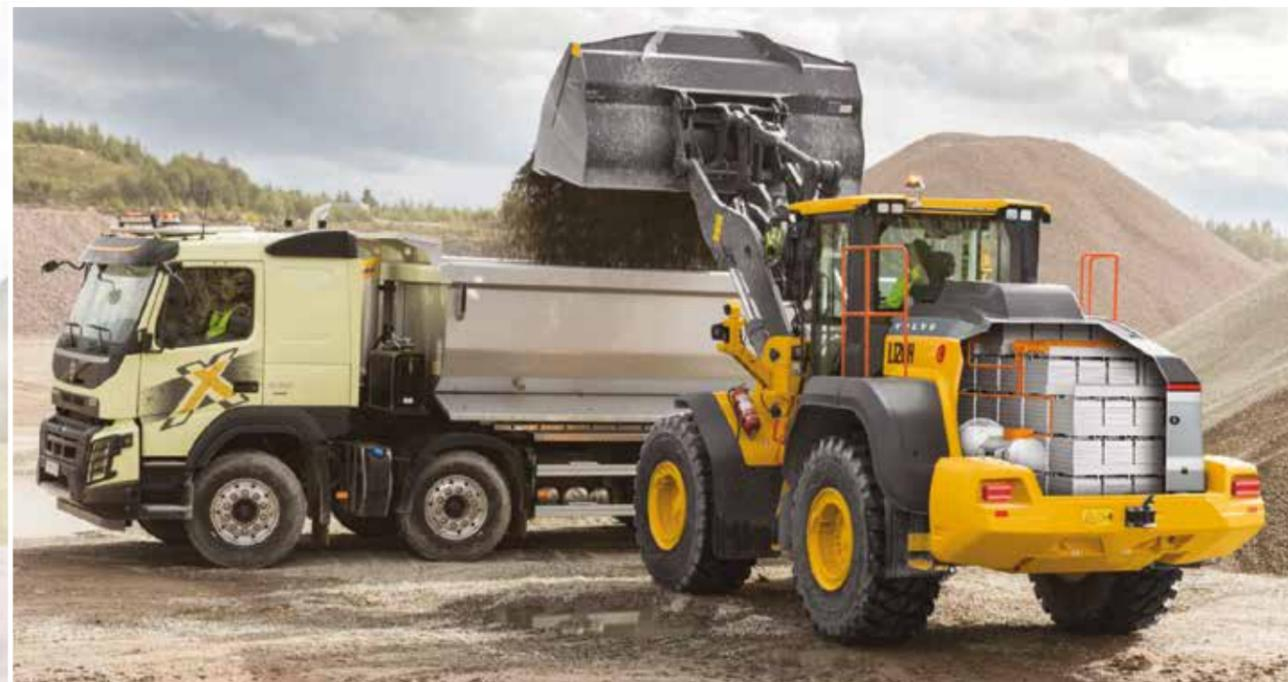
in Europa nel corso del 2023. La base della nuova pala, manco a dirlo, è la popolare versione con motore 6 cilindri da 203 kW di potenza massima che rimane in commercio. Volvo CE precisa che la L120H Electric offre esattamente le stesse prestazioni della versione termica ma a zero emissioni.
