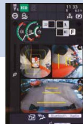
**INQUADRATURE MOLTEPLICI** Il nuovo software permette di personalizzare le telecamere visualizzate a monitor.
