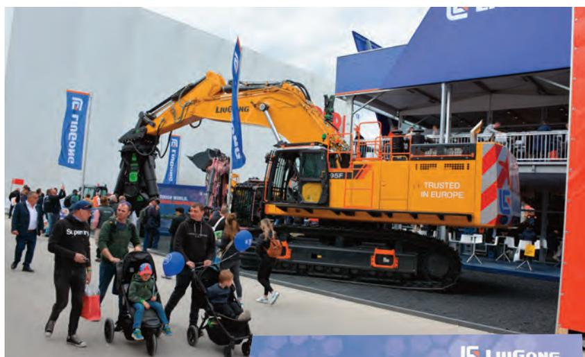
**995F** È l'ammiraglia degli escavatori LiuGong, pesa 95 t, ha un motore Perkins. Esiste anche in versione elettrica alimentata con cavo avvolgibile lungo 150 m.
