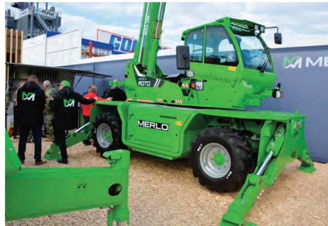
**NUOVI ROTO** Merlo ha riprogettato molti componenti, inclusi il braccio telescopico, il circuito idraulico, l'elettronica, mantenendo la compattezza e la leggerezza che contraddistinguono i ROTO, per ottimizzare le prestazioni. Ogni modello della gamma fa segnare un incremento della portata utile fino a 1.000 kg e un'altezza di sollevamento massima aumentata di 1 m. La velocità massima raggiunge i 40 km/h.
