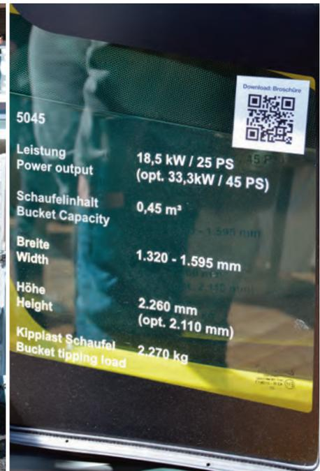
**5045** La nuova Kramer 5045 con telaio rigido e quattro ruote sterzanti, garantisce massima stabilità e manovrabilità anche negli spazi più stretti, come cantieri urbani, aree industriali o aziende agricole. La macchina è spinta da un motore diesel Stage V da 18,5 o 33,3 kW (opzionale), in grado di assicurare il giusto mix tra efficienza, prestazioni e consumi contenuti. La capacità della benna
