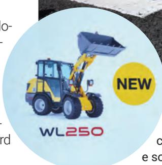
**WL250, WL300e** Le pale gommata compatte Wacker Neuson WL250 (diesel) e WL300e (elettrica) offrono le stesse prestazioni in termini di carico e dimensioni, con benna standard da 0,5 m<sup>3</sup>, per un lavoro efficiente e sostenibile in contesti operativi differenti.
