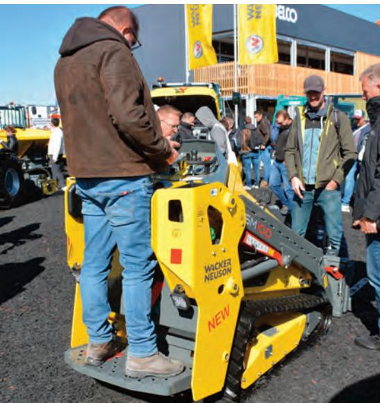
**SM100** Super compatta, ha un motore diesel Yanmar da 18,4 kW, cingoli da 230 mm, capacità di carico fino a 647 kg, linea Aux da 49 l/min di portata e un'altezza al perno benna di 2.176 mm.
