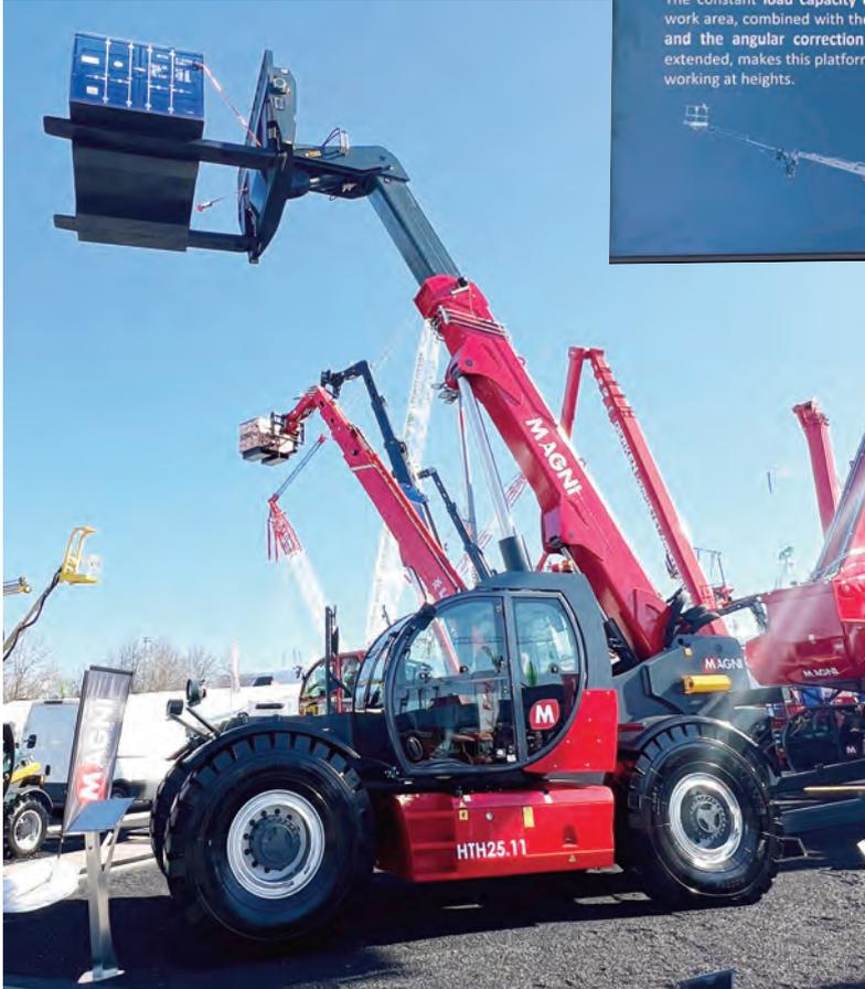
**SUPER CESTA** Progettata per i rotativi Magni, la piattaforma TP 4,5.10 offre una capacità di carico di 450 kg su tutta l'area di lavoro. Il suo sistema di rotazione innovativo consente una rotazione di 360° con il braccio represso e un'angolazione correttiva di ±20° con il braccio esteso, migliorando la flessibilità operativa.
