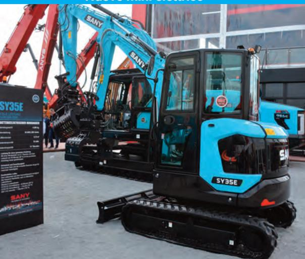
**SY35E** Se l'SY19e visto a Bauma 2022 come prototipo è ora un modello di serie, al suo fianco debutta il nuovo SY35E da 3,5 t di peso operativo. Alimentato da batterie al litio ferro-fosfato che assicurano oltre 3.500 cicli di carica, offre fino a 6 ore di autonomia, riduce i consumi del 30% e abbatta i costi operativi fino all'80%. Siamo curiosi di scoprire il prezzo di listino.
