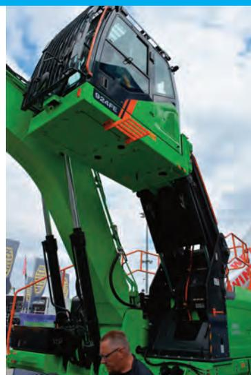
Questo cingolato elettrico da 28,1 tonnellate, progettato per applicazioni in impianti di riciclaggio ha la cabina elevabile fino a 2,5 metri. La batteria è una LFP da 423 kWh di capacità.
