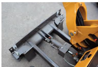
**NEL DETTAGLIO** Se parliamo di finiture, le possiamo dire perfettibili. Ma la sostanza c'è: blocco brandeggio in fusione, tubazioni idrauliche lineari, design che ricorda marchi molto noti...
