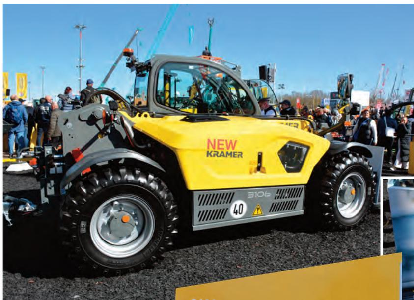
**3106** Il nuovo Kramer è un'evoluzione che combina potenza, compattezza e tecnologia. In particolare, la cabina è stata aggiornata con un nuovo display multifunzione per la gestione della pesa e dei principali parametri operativi. Confermata la trasmissione idrostatica e la sterzata integrale per garantire precisione e stabilità su ogni tipo di terreno.
