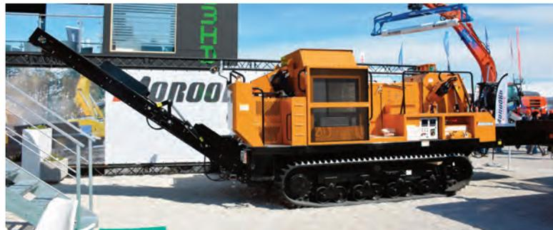
**TRINCIA FORESTALE MRC3000** Esposta per la prima volta in Europa, questa macchina divora tronchi d'albero. È larga appena 2.400 mm, pesa 13.700 mkg ed è motorizzata con motore CAT C7.1 da 186,5 kW di potenza. È in fase di sviluppo l'upgrade dalla versione Stage IV alla nostrana Stage V. Molto interessante.
